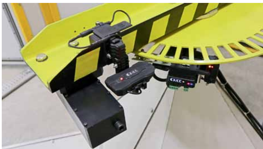
Рис. 7. Инфракрасные датчики частоты вращения и контроля срабатывания ЦВ
