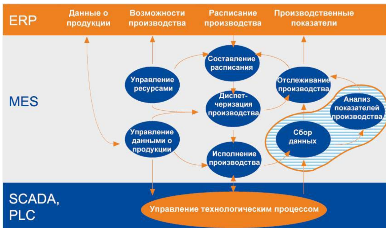
Рисунок 2. Место систем OEE/DTM в стандарте ISA 95
