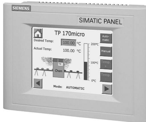
Рис. 4б. Сенсорная панель TP 170 micro
