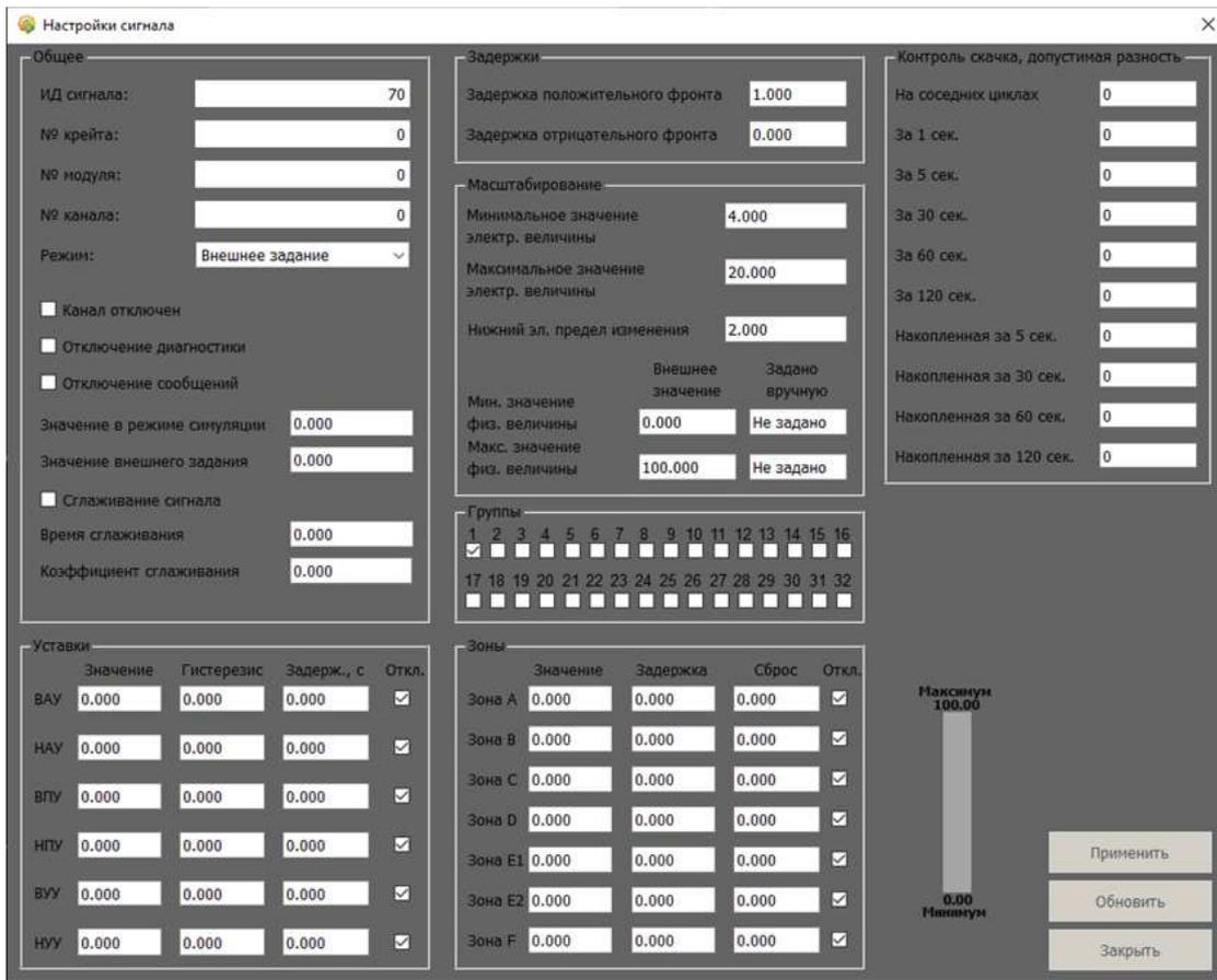
Рисунок 114 – Окно настройки аналогового сигнала в модуле "Вибромониторинг"
